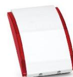
Sirène intérieure • Finition blanche avec lampe flash rouge intégrée • Commande par apparition du 12Vdc • Choix entre 3 tonalités de sirène • Rendement sonore de 120 dBA à 1 mètre • Consommation maximale de 300mA en alarme • Dimensions (L x H x P): 87 x 133 x 37 mm
