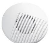
Sirène intérieure • Finition blanche • Version autonome par commande 12Vdc avec possibilité d'utiliser une batterie backup type 6LR61 de 9Vdc (non-incluse) • Choix entre 3 tonalités de sirène • Rendement sonore de 120 dBA à 1 mètre • Consommation de 330mA • Dimensions (L x H x P): 130 x 130 x 40 mm
