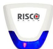
Sirène extérieure avec flash • Finition blanche en polycarbonate à haute résistance mécanique et protection UV • Flash intégré sur base d'une led SLT avec plexi bleu • Volume sonore 114 dBA • Température de fonctionnement: -25 à 60°C • Dimensions (L x H x P): 277 x 236 x 50 mm • Commande classique possible ou raccordement via le BUS Risco de 4 fil • Batterie d'urgence NiMH rechargeable, 8,4V / 280mAh ! A utiliser en combinaison avec le système ProSYS Plus, LightSYS et LightSYS+.
