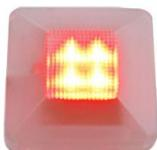
LED de signalisation • Couleur LED: Rouge • Possibilité de commande: continu & clignotant (1Hz) • Qualification d'environnement: IP67 • Température de fonctionnement: -10 / +55 °C • Tension de fonctionnement: 10,5 à 29 Vdc • Consommation: 35mA • Câble de raccordement: 1m • Boîtier: Blanc & transparent • Dimensions (L x H x P): 58 x 58 x 20 mm
