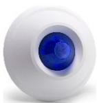
Led de signalisation • Couleur led: Bleu • 4 possibilités de commande: continu, clignotement lent ou rapide, double clignotement avec intervalle • Possibilité de commande par apparition d'une tension de commande (12VDC ou masse commune) • Equipé d'un contact sabotage • Température de fonctionnement: -10 / +55 °C • Tension de fonctionnement: 12 Vdc ±15% • Consommation: 85mA • Raccordement à vis • Boîtier: Blanc & transparent • Dimensions (Ø x H): 97 x 37 mm
